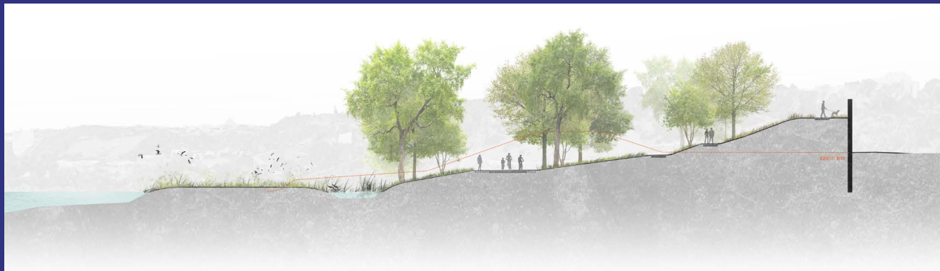
Řez Trojským nábrežím u nového ostrova v místě přispání protipovodňové zdi chránící Zoo před povodní. Blíže k řece vede cyklostezka, dále od vody nové pěšiny.
